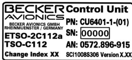
Abb 2-2: Typenschild CU6401 (Beispiel)
